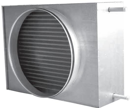
Используются в системах вентиляции. Нагреватели AVSV изготовлены из медных трубок и алюминиевых пластин. Корпус изготовлен из оцинкованной жести. Крышка легко снимается после откручивания 4 винтов. Чистка и проверка нагревателя осуществляются после снятия верхней крышки.
