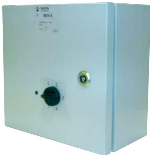
Трансформаторные регуляторы скорости TGTV предназначены для изменения скорости вращения вентиляторов (-3 Ф, 400 Вт, 50 Гц). Встроенные в регулятор автотрансформаторы регулируют напряжение питания вентилятора. Все регуляторы напряжения оснащены контактами подключения термозащиты двигателя.
