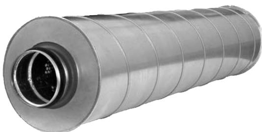
Глушители LDCV хорошо подавляют шум, устанавливаются в системы круглых воздуховодов. Изменение давления в глушителях почти такое же, как в воздуховодах вентиляционных систем. При высоком уровне шума в системы круглых воздуховодов устанавливаются несколько глушителей. Корпус изготовлен из оцинкованной жестяной ленты, которая сворачивается в трубу SPIRO. Внутренняя стенка изготовлена из перфорированной листовой оцинкованной жести и заполнена звукоизолирующей минеральной ватой.
