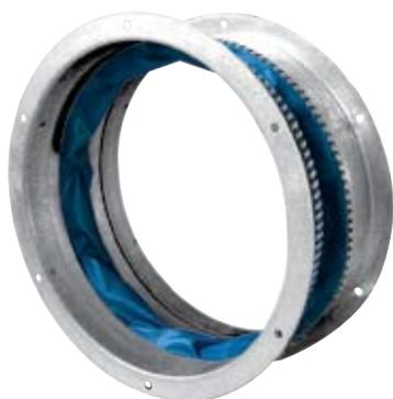
Гибкое соединение LSVV изготовлено из оцинкованного стального листа и неопреновой ткани. Предназначено для подавления колебаний вентилятора VSVV.
