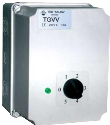
Трансформаторные регуляторы скорости TGVV предназначены для изменения скорости вращения вентиляторов (-1 Ф, 230 В, 50 Гц). Встроенный в регулятор автотрансформатор регулирует напряжение питания вентилятора. Все регуляторы (за исключением TGVV 1,5 и TGVV 2) оснащены контактами подключения термозащиты. Регуляторы TGVV 1,5, TGVV 2 могут не иметь контактов подключения термозащиты.
