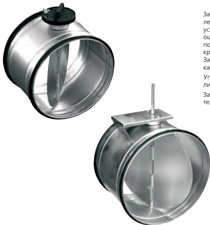
Заслонки SK, SKM для запора и регулировки воздушного потока легко устанавливаются в систему круглых воздуховодов. Могут устанавливаться в любом положении. Корпус изготовлен из оцинкованной жести. Запорные лопатки могут поворачиваться под углом 0 – 90° с помощью ручки (ручка заслонки SK прикреплена одним винтом) или двигателей (для заслонок SKM). Заслонка спроектирована таким образом, чтобы производить как можно меньше шума.
