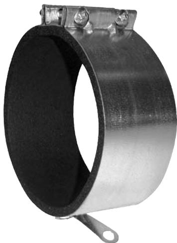
Хомуты MKV применяются в монтаже различных элементов систем вентиляции и кондиционирования. Они подавляют вибрацию и обеспечивают прочный монтаж различных деталей системы. Изготовлены из оцинкованной стали.
