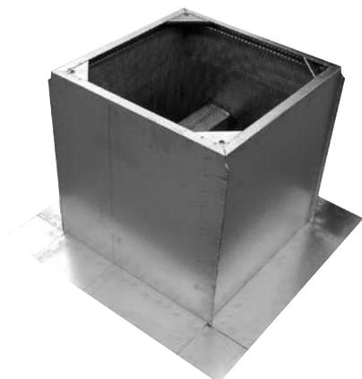
Короб KSPV изготовлен из оцинкованной стали. Предназначен для монтажа крышных вентиляторов VSVV на плоской крыше. Шумоподавляющий материал обладает стойкостью к износу, если скорость воздуха не превышает 20 м/с.
