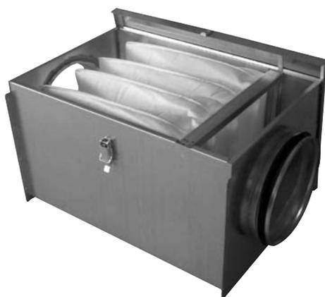
Кассеты фильтров FDIV для очистки воздуха. Подключаются к круглым воздуховодам. Комплекуются карманными фильтрами типа FMKV (класса EU3-EU5-EU7). Корпус фильтра изготовлен из оцинкованной жести. Соединительный фланец кассеты фильтров изготавливается с уплотнительной резиной. Обзорная крышка легко снимается, крепится к корпусу одним шарниром.
