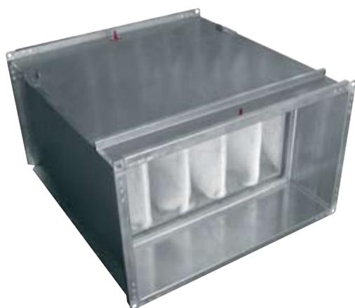
Кассеты фильтров FDSV для очистки воздуха. Устанавливаются в систему прямоугольных воздуховодов, комплектуются карманными фильтрами типа FMKV (класса EU3-EU5-EU7). Карманный фильтр монтируется в кассете в горизонтальном положении, либо карманами вниз. Корпус изготовлен из оцинкованной жести. К кассетам фильтров FDSV можно подключать датчики давления.
