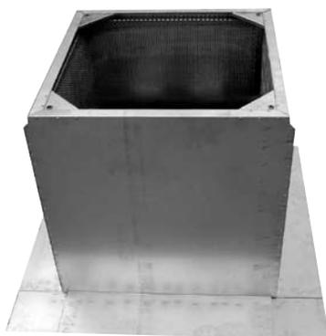
Короб KSV изготовлен из оцинкованной стали. Предназначен для монтажа крышных вентиляторов VSVV на плоской крыше. Толщина изоляции 50 мм.
