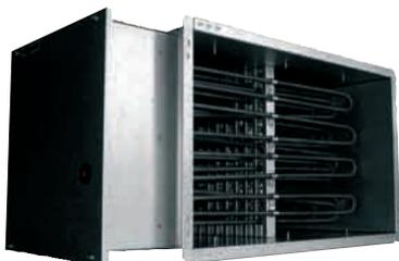
Прямоугольные каналные нагреватели, предназначены для подогрева чистого воздуха в вентиляционных системах. Корпус изготовлен из алюмоцинкованной стали, поверхность которой устойчива к высоким температурам. Трубка тена изготовлена из нержавеющей стали AISI 304. В нагревателе установлены 2 термозащиты, клеммы электрического подключения. Корпус может быть изготовлен с PG соединением, фланшами или для монтажа в вентиляционном агрегате.
